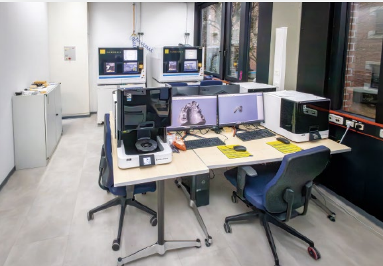
► Das Equipment umfasst unter anderem Laborscanner und 5-Achs-Fräsen.
