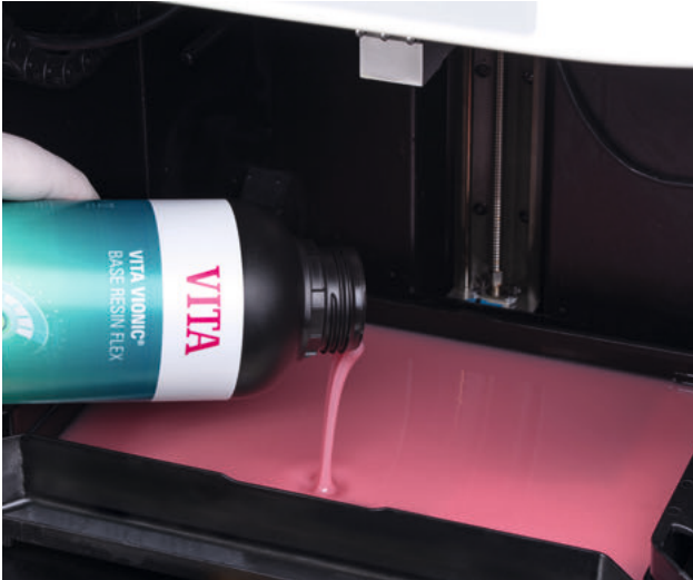
➤ VITA VIONIC BASE RESIN FLEX wird in die Harzwanne des 3D-Druckers eingefüllt.
