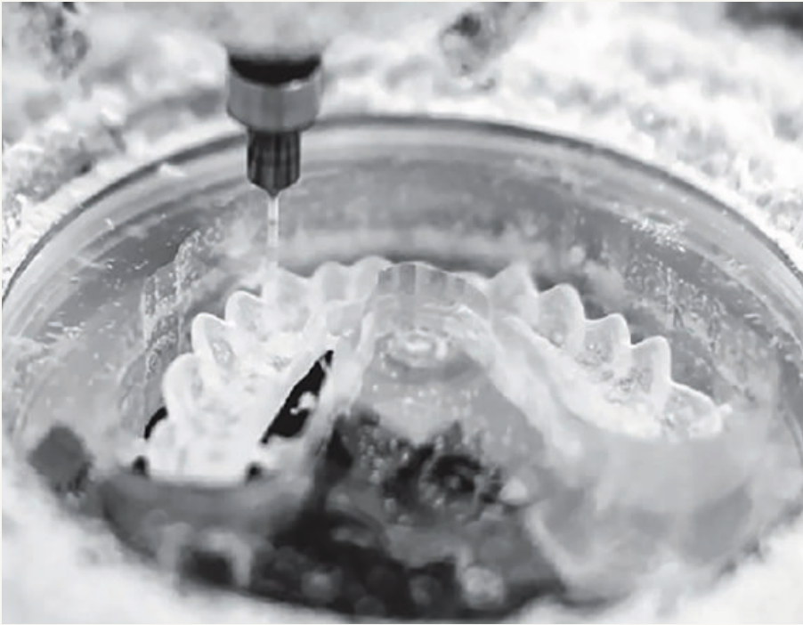
◀ 2 Fräsprozess zur Schienenherstellung
